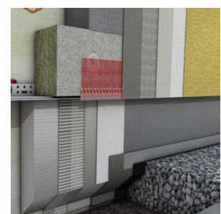
Veetõkkemastiks, profileeritud dreanaažimatt ja killustikust dreanaažikiht.
